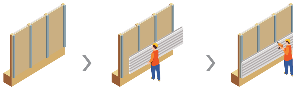
벽에 시공 구조체 설치 및 레인스크린 부자재 시공
