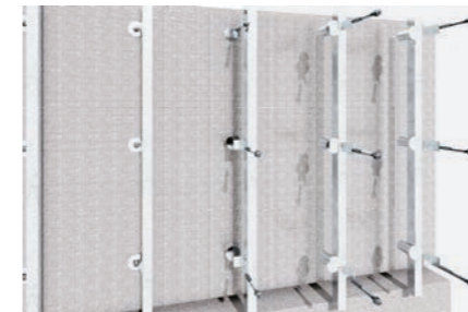
각관 하지 공사
