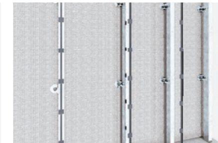
드레인 스트랩 설치
